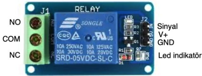
Şekil-9: Röle kartı duyargası ayak yapısı [10]
