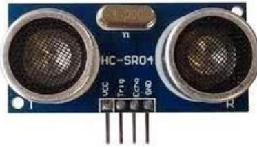
Şekil-8: HC-SR04 ultrasonik mesafe duyargası ayak yapısı [24]
