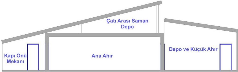
Şekil 4.23 Geleneksel konut tipolojisi kısa kesit (Yazar tarafından oluşturulmuştur.)
